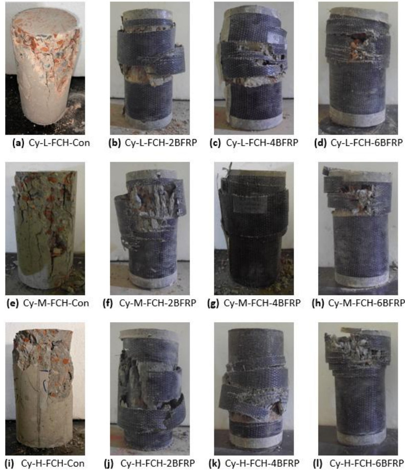
Figure 5. Failure types of Group 2 cylinders: (a) Cy-L-FCH-Con; (b) Cy-L-FCH-2BFRP; (c) Cy-L-FCH-4BFRP; (d) Cy-FCH-6BFRP; (e) Cy-M-FCH-Con; (f) Cy-M-FCH-2BFRP; (g) Cy-M-FCH-4BFRP; (h) Cy-M-FCH-6BFRP; (i) Cy-H-FCH-Con; (j) Cy-H-FCH-2BFRP; (k) Cy-H-FCH-4BFRP; (l) Cy-H-FCH-6BFRP.
