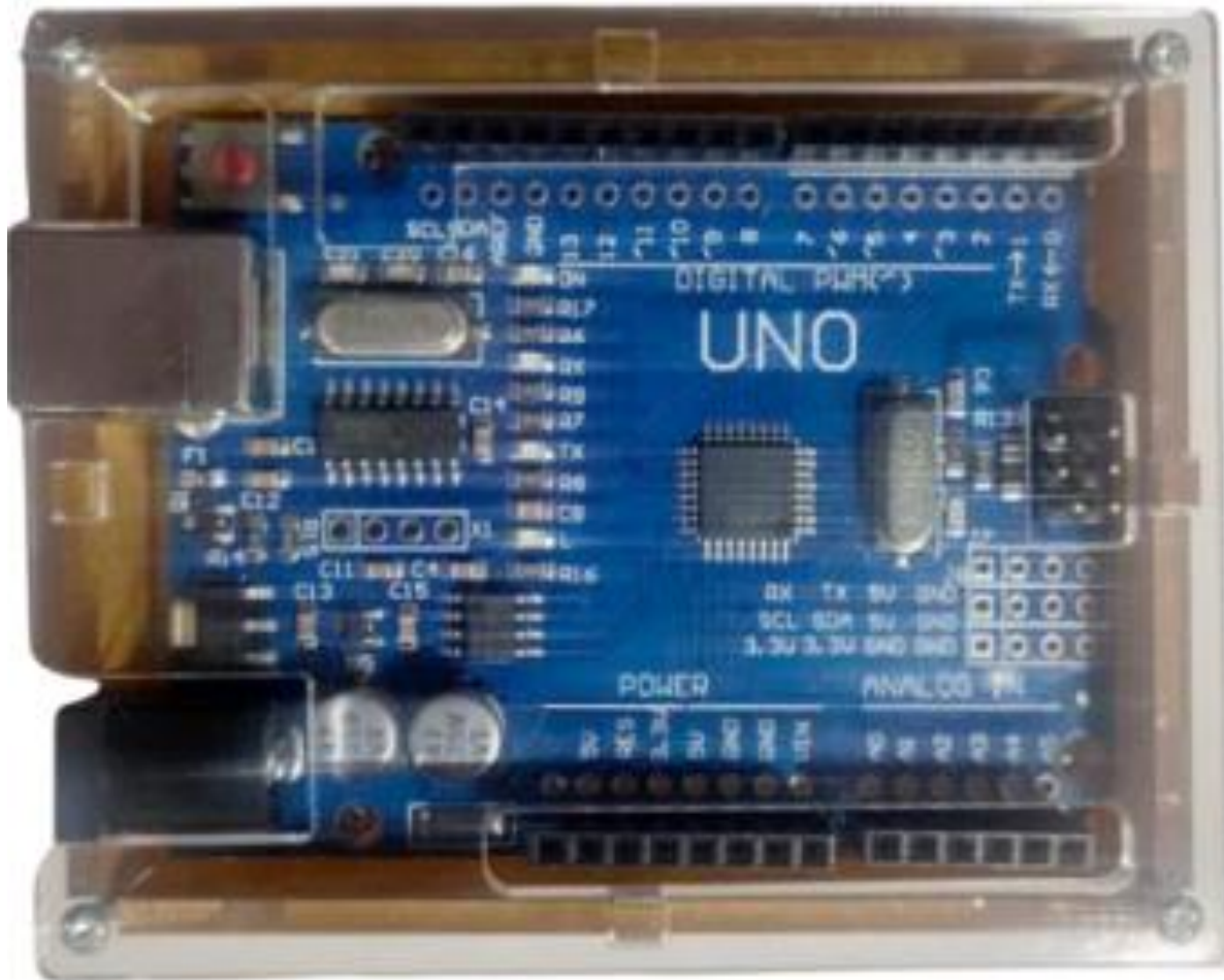
Figure 2. Arduino UNO ATmega328.
