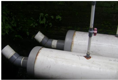
Gambar 1. Set alat pengolahan biogas dari kotoran sapi.
