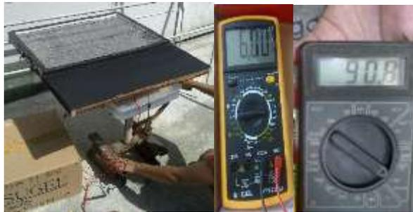
Gambar 7. Hasil pengujian sementara (avometer kuning menunjukkan tegangan dalam V, avometer hitam menunjukkan arus dalam mA)
