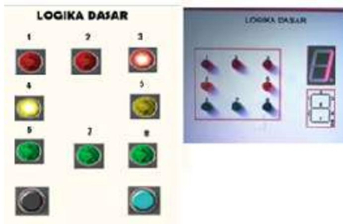
Gambar 11. kondisi lampu 3 dan 4 nyala pada HMI sedangkan pada seven segmen membentuk angka 1
