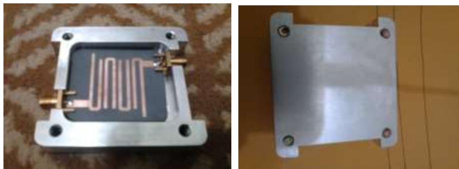
Gambar 9. Hasil Fabrikasi BPF dengan Casing
