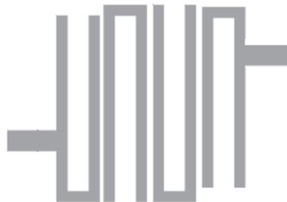
Gambar 3. *Filter hairpin* dengan empat buah *resonator/pole* [6]
