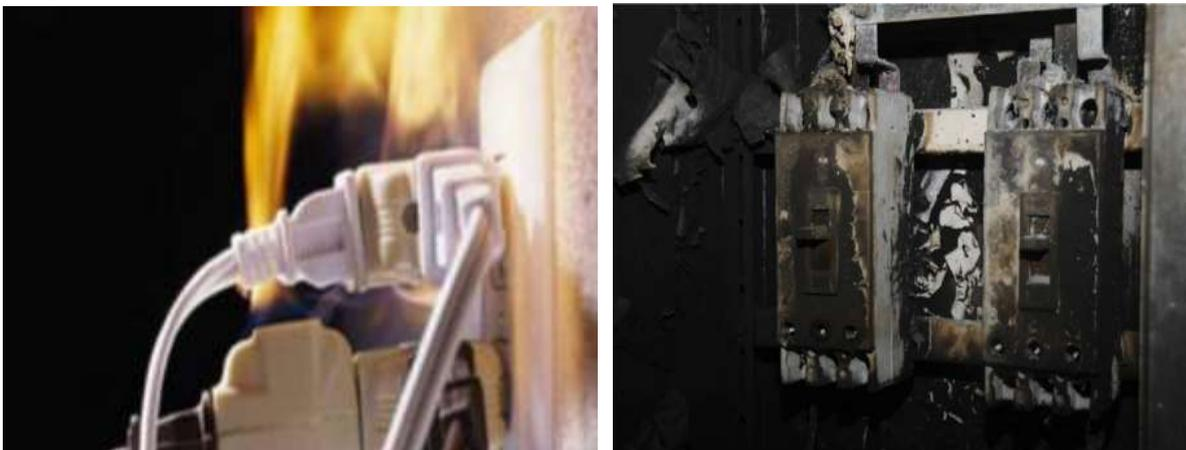
Gambar 1. Ilustrasi pemakaian steker dan panel MCB yang terbakar
