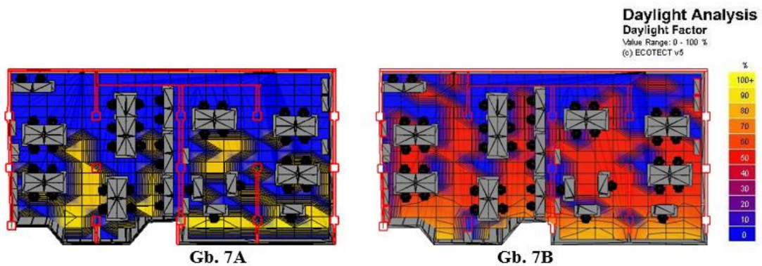
Gambar 7. Sampel Titik Ukur Intensitas Pencahayaan Alami (Kiri: Kondisi Eksisting Kanan: Sesudah)
