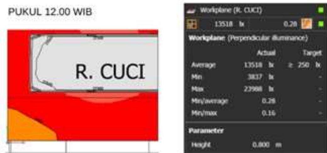
Gambar 6. Kondisi ruang cuci pada pukul 12.00 WIB setelah ditambahkan pencahayaan buatan
