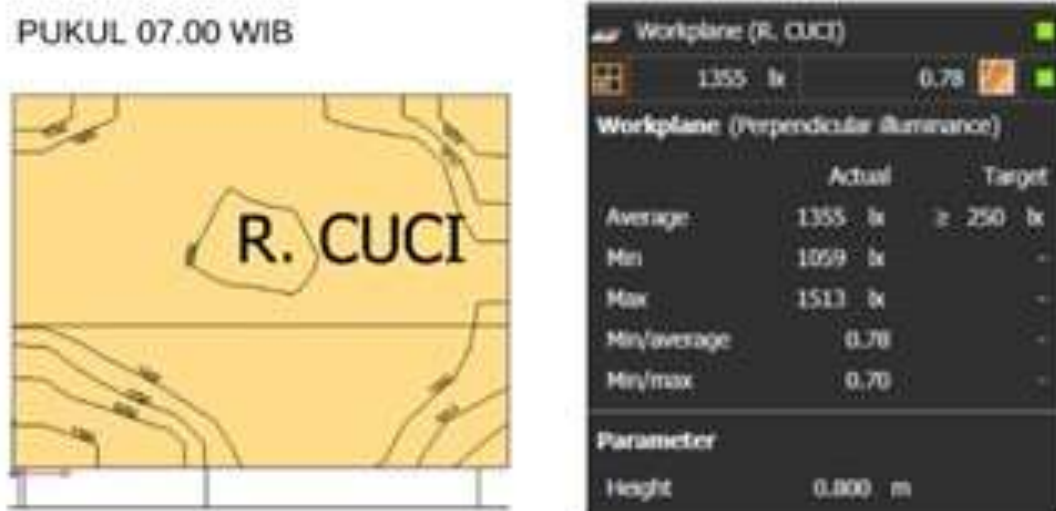
Gambar 5. Kondisi ruang cuci pukul 07.00 WIB setelah ditambahkan pencahayaan buatan
