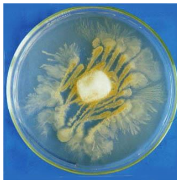
Gambar 2 Foto film kopolimer PHB/CL setelah waktu inkubasi 21 hari. Tampak mikroorganisme sudah tumbuh pada seluruh permukaan film.
