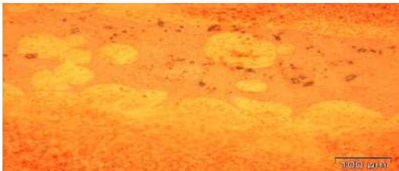
Gambar 8. Struktur mikro hasil brazing dengan OAW setelah dietsa
