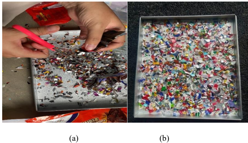
Gambar 5. (a) Sampah plastik yang dipotong menjadi ukuran yang lebih kecil dan (b) Hasil sampah plastik yang sudah diberi resin yang dicampur dengan katalis
