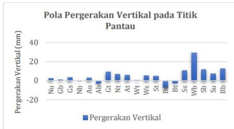
Gambar 3. Grafik pola pergerakan vertikal pada titik pantau
