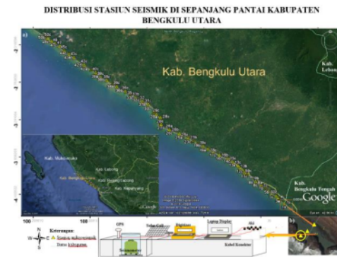
Gambar 2. Survei desain pengumpulan data. (a). Sebaran stasiun perekaman data mikrotremor di daerah studi; (b). Ilustrasi teknik pemasangan seismometer di setiap lokasi pengukuran.
